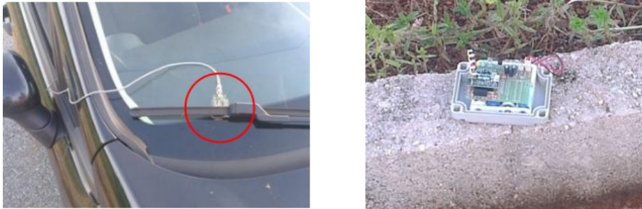
Figura 2. Dispositivo fixado no automóvel, para simulação de um gateway móvel (à esquerda). Nó sensor posicionado na via (à direita).
